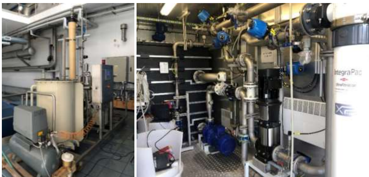
Rysunek 22 Stacje pilotażowe do mikrofiltracji na kapilarach o średnicy 0,1\mu\text{m} firmy Asahi Kasai (po lewej) oraz do ultrafiltracji na kapilarach o średnicy 0,03\mu\text{m} firmy DOW (po prawej).
