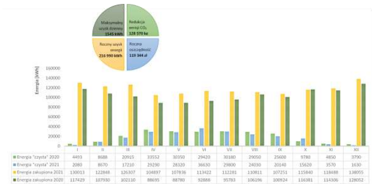
Rysunek 14 Uzysk energii elektrycznej wyprodukowanej na farmie fotowoltaicznej 'Westerplatte'
