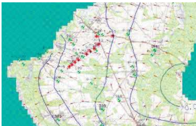
Rysunek 15 Zaktualizowane kierunki spływów wód w warstwie wodonośnej uzyskane w oparciu o modelowanie matematyczne dla ujęcia wody w Głobinie
