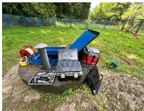
Rysunek 15 Regeneracja studni głębinowej 13b oraz pomiar wydajności studni po regeneracji
